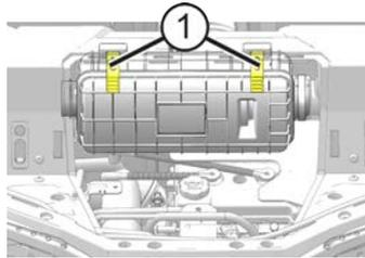
4. Luftfilter ② und -gehäuse auf Schmutz, Rückstände oder Wasser prüfen.
