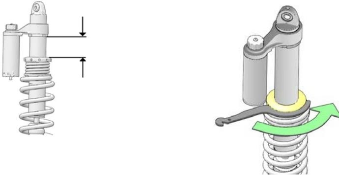
1. Zunächst das Fahrzeug aufbocken, bis die Federung vollständig durchhängt.
