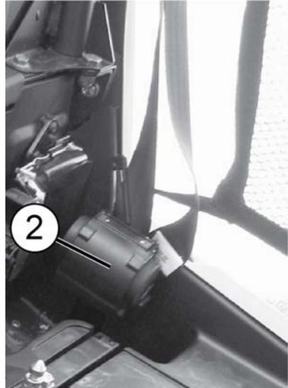
1. Die Gurtöse in die Schnalle einführen und hörbar einrasten lassen. Die Gurtöse muss sich leicht in die Schnalle einführen lassen. Am Klickgeräusch ist zu erkennen, dass der Gurt sicher eingerastet ist.
