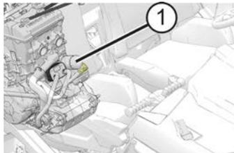
7. Die Filterdichtflächen am Kurbelgehäuse mit einem sauberen, trockenen Lappen reinigen.
