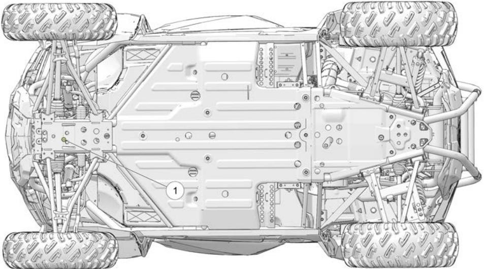
1. Einfüllschraube herausdrehen.
