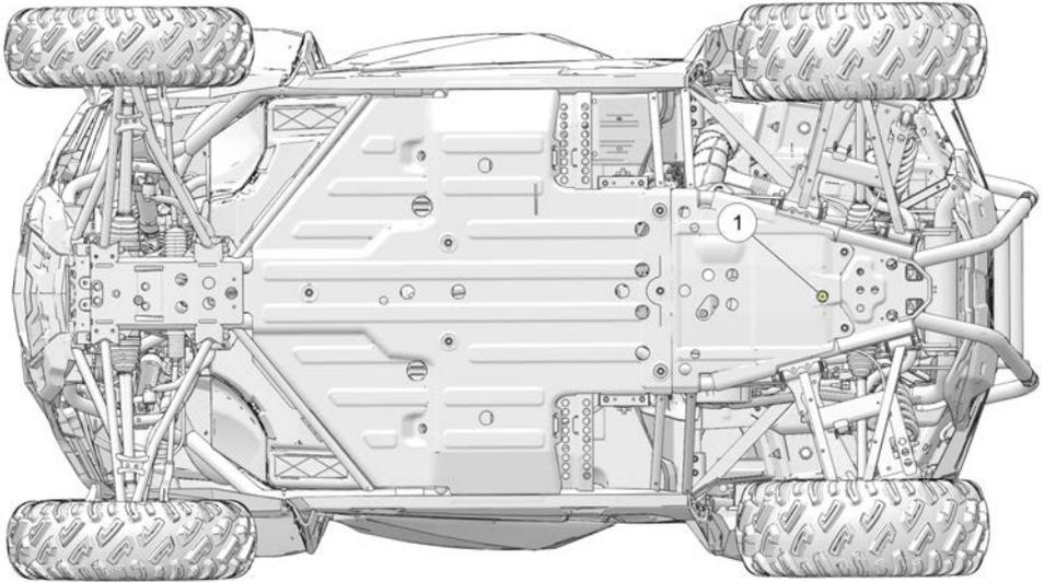
1. Einfüllschraube herausdrehen.
