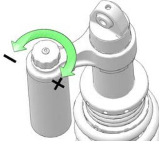
1. Um die Druckstufendämpfung zu erhöhen, den Klickversteller im Uhrzeigersinn drehen.
