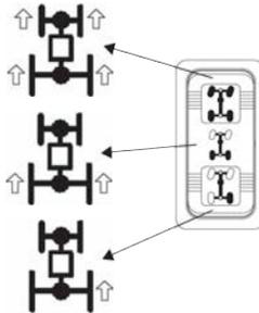
Durch Drücken auf den unteren Teil des Schalters wird die Differenzialsperre abgeschaltet, so dass die Hinterräder voneinander unabhängig angetrieben werden. Diese Betriebsart eignet sich gut für grasbewachsenen Untergrund oder Bodenverhältnisse, die keine besonders hohe Reifenzugkraft erfordern.
