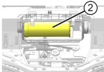
5. Zum Abnehmen des Filters den Filter zur Beifahrerseite des Fahrzeugs schieben.
