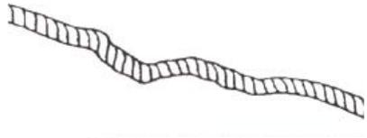
Windenseile aus Synthetikfasern müssen auf Ausfransen hin kontrolliert werden. Bei Anzeichen von Ausfransen ist das Seil auszuwechseln (siehe rechts). Ein Windenseil in diesem Zustand darf nicht mehr benutzt werden. Das Windenseil ist ferner auszuwechseln, wenn Fasern zusammengeschweißst oder angeschmort sind. An solchen Stellen ist das Synthetikfaserseil steif und sieht glatt oder blank aus. Ein Windenseil in diesem Zustand darf nicht mehr benutzt werden.
