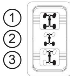
Wenn sich der Schalter in Stellung 2x4 befindet, fährt das Fahrzeug kontinuierlich mit Zweiradantrieb. In der Schalterstellung AWD ist der Allradantrieb des Fahrzeugs aktiviert. Auf dem Kombiinstrument leuchtet die 4x4-Anzeige.
