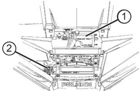
4. Deckel ② abnehmen und mit einem Trichter so viel Kühlmittel einfüllen, bis es zwischen den beiden Markierungen steht.
