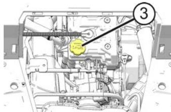
8. Einfülldeckel wieder anbringen. Ölmesstab wieder einsetzen.
