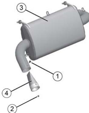
4. Das Sieb auf Abnutzungserscheinungen und Schäden prüfen. Wenn es abgenutzt oder schadhaft ist, ein neues Sieb einbauen.
