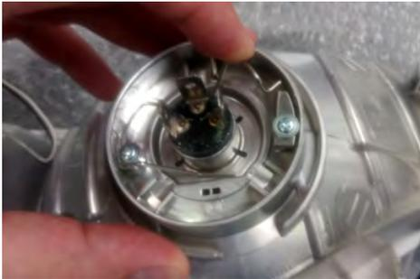
5. Neue Glühlampe in das Gehäuse einsetzen.
