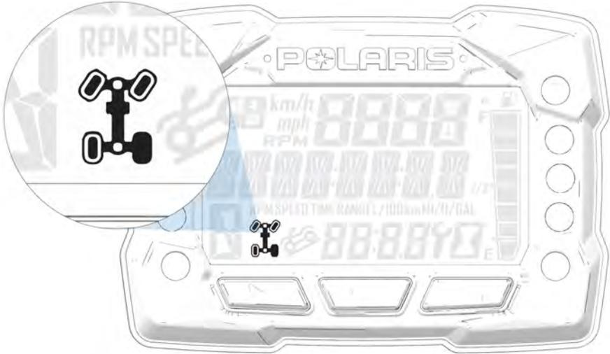
Das Allradantriebssystem wird mit dem Triebstrang-Schalter ① zu- und abgeschaltet. Der Allradantrieb (AWD) muss zugeschaltet werden, bevor das Fahrzeug in einen Bereich gerät, in dem es auf den Vorderradantrieb angewiesen sein könnte. Wenn die Hinterräder durchdrehen, Gaspedal vor dem Zuschalten des Allradantriebs freigeben.
