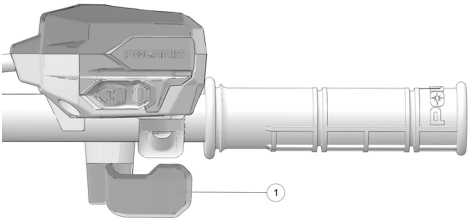
Die Motordrehzahl und die Fahrgeschwindigkeit werden durch Betätigen des Gashebels ① reguliert. Der Gashebel ist federbelastet. Wird der Hebel freigegeben, kehrt der Motor zur Leerlaufdrehzahl zurück.
