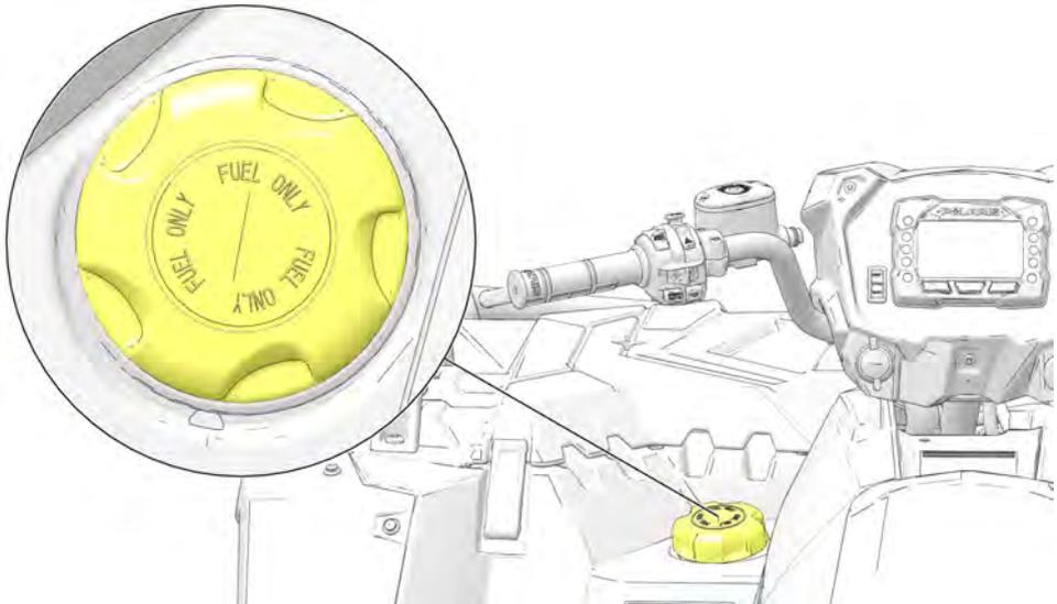
Kraftstofftankdeckel abnehmen um Tank aufzufüllen. Das Fahrzeug ist mit verbleitem oder bleifreiem Benzin mit einer Nenn-Oktanzahl von mindestens 87 = (R + M/2) zu betanken. Keine Kraftstoffe mit einem Ethanolgehalt von mehr als 10 %, wie z. B. E-85, verwenden.
