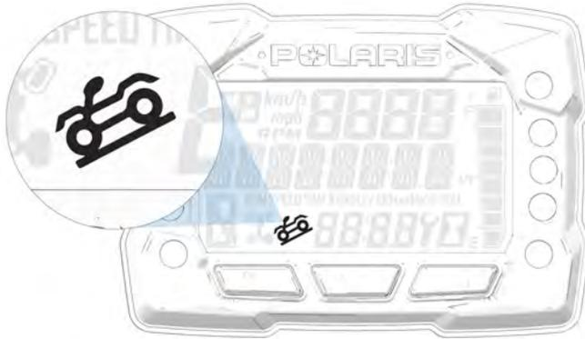
Mit der Allrad-Bergabfahrhilfe (4WDC) können alle vier Räder des Fahrzeugs an Steigungen oder im Gefälle mit dem Motor abgebremst werden. Vor einer Bergauf- oder Bergabfahrt stets den Allrad-Bergabfahrhilfe-Modus (sofern vorhanden) zuschalten.
