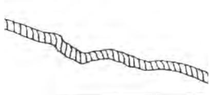
Windenseile aus Synthetikfasern müssen auf Ausfransen hin kontrolliert werden. Bei Anzeichen von Ausfransen ist das Seil auszuwechseln (siehe rechts). Ein Windenseil in diesem Zustand darf nicht mehr benutzt werden. Das Windenseil ist ferner auszuwechseln, wenn Fasern zusammengeschweißt oder angeschmort sind. An solchen Stellen ist das Synthetikfaserseil steif und sieht glatt oder blank aus. Ein Windenseil in diesem Zustand darf nicht mehr benutzt werden.
