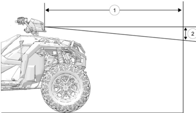
1. Fahrzeug auf ebenem Untergrund so aufstellen, dass sich die Scheinwerfer etwa 7,6 m (25 ft) von einer Wand ① entfernt befinden. Ganghebel in Stellung PARKEN (P) bringen.
