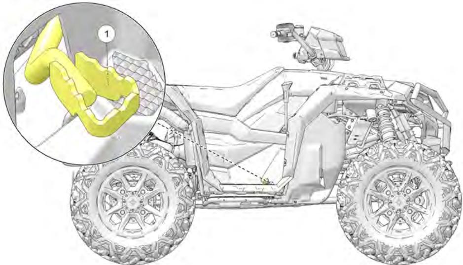
Die Hilfsbremsanlage ist als Ergänzung der Hauptbremsanlage konzipiert. Sollte die Hauptbremsanlage ausfallen, dient die fußbetätigte Hilfsbremse ① als Ersatz.
