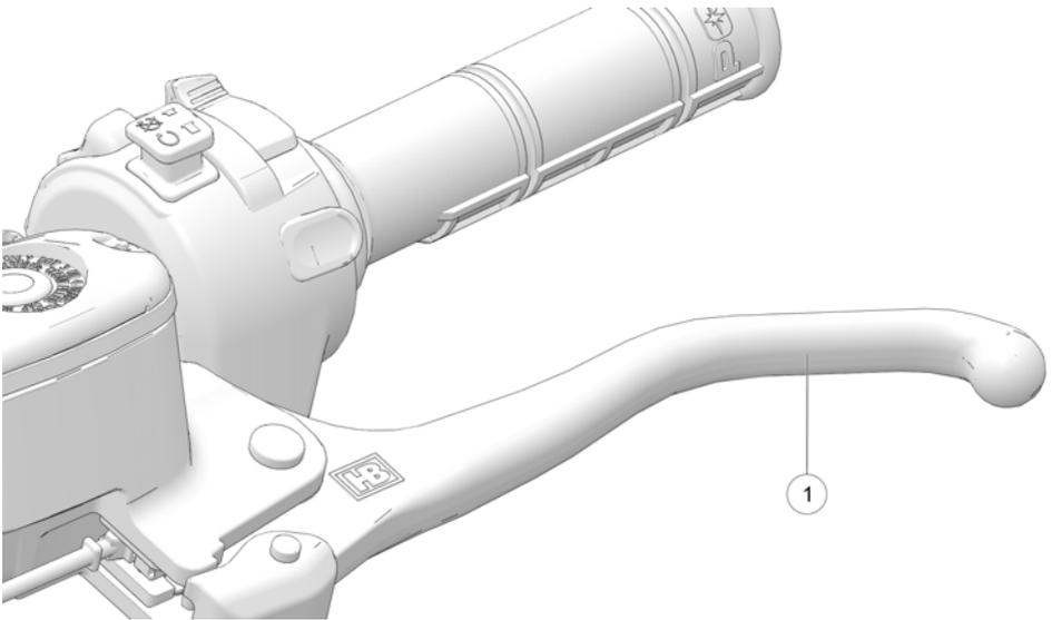
Wenn man den Bremshebel betätigt, muss ein deutlicher Widerstand spürbar sein. Fühlt sich der Hebel schwammig an, deutet dies auf eine mögliche Undichtigkeit von Bremsleitungen oder einen zu niedrigen Füllstand des Hauptbremszylinders hin. Beides ist ggf. vor der Fahrt zu beheben. Bezüglich einer sachgerechten Diagnose und Reparatur bitte einen POLARIS-Händler oder einen anderen qualifizierten Wartungsbetrieb aufsuchen.
